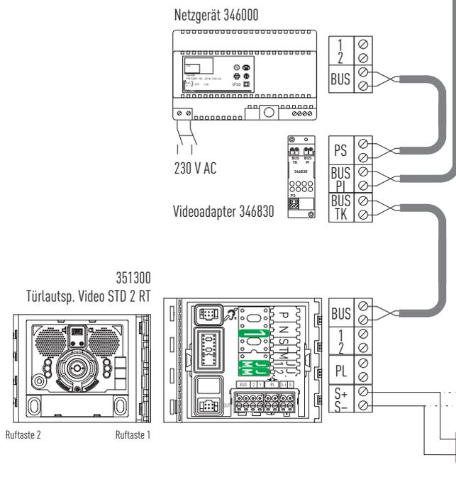
Falls erforderlich, kann unter Verwendung des im Lieferumfang enthaltenen Relais (346250) der Türöffnerausgang des Lautsprechers potenzialfrei geschaltet werden. Hierfür die unten angeführte Schaltzeichnung verwenden.
