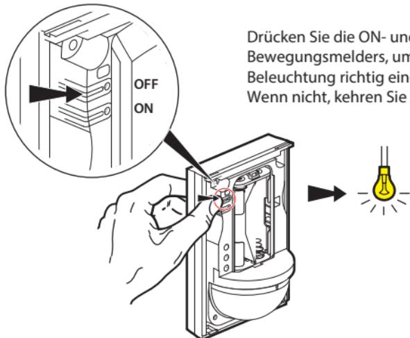
Drücken Sie die ON- und OFF-Tasten des drahtlosen Bewegungsmelders, um zu überprüfen, ob die Beleuchtung richtig ein- und ausgeschaltet wird.
