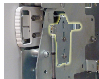
Les pièces Z, des deux appareils, devront être installées en translation, comme sur la photo
