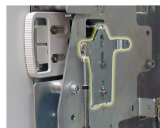
Les pièces Z, des trois appareils, devront être installées en translation, comme sur la photo
