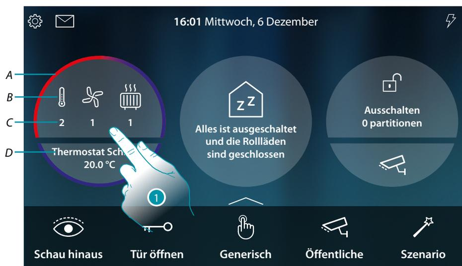
A Zeigt durch eine Farbe an (rot für Heizen, hellblau für Kühlen), dass mindestens eine der Vorrichtungen aktiv ist
