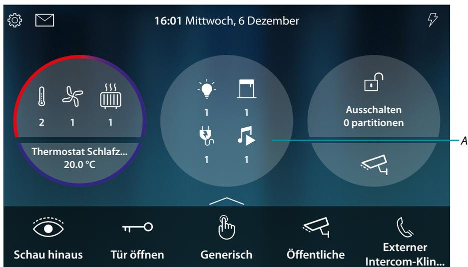
Im Haus-Statusbereich werden die aktiven Geräte und deren Nummer angezeigt. Durch Berühren (A), wird eine Verwaltungsseite geöffnet
