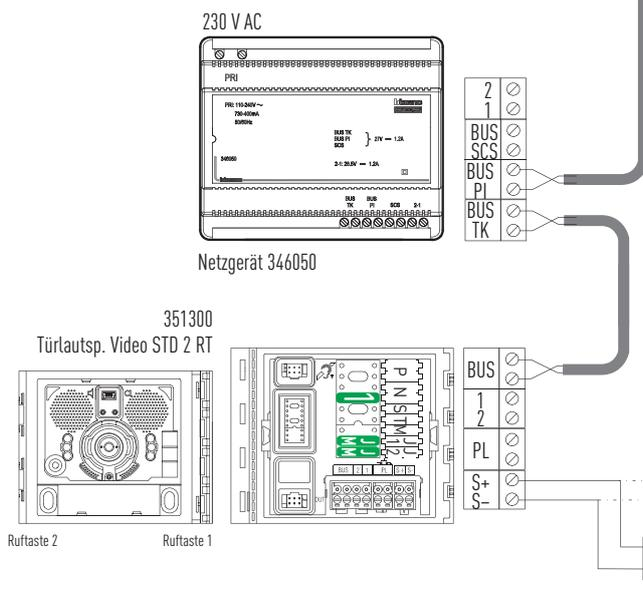
Falls erforderlich, kann unter Verwendung des im Lieferumfang enthaltenen Relais (346250) der Türöffnerausgang des Lautsprechers potenzialfrei geschaltet werden. Hierfür die unten angeführte Schaltzeichnung verwenden.
